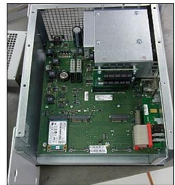
3. Legen Sie die JC-965EXT-E03-2 auf die Seite mit den Kühllamellen und demontieren Sie die Seitenabdeckung.
