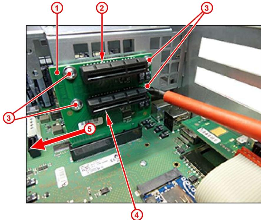
1. Lösen Sie etwas die 4 Befestigungsschrauben (3).
