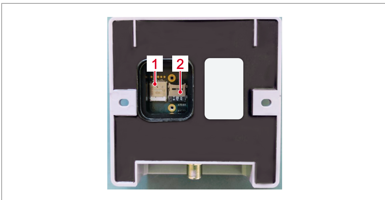
Abb. 10: Steckplätze – SIM-Karte und microSD-Karte
